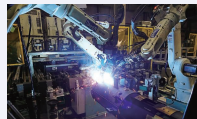
柱上変圧器ケースの溶接自動化工程
