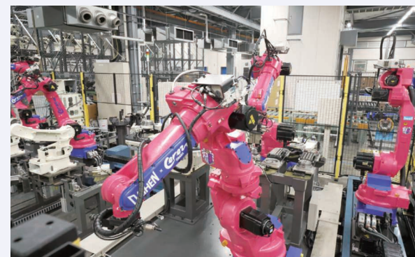
複数ロボットでの組み立て工程
