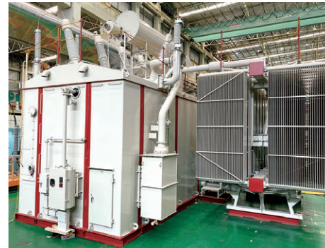
工場試験中変圧器
