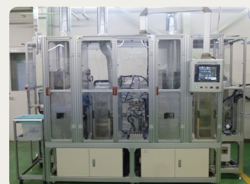
可溶体はんだ付け自動化装置による効率化
