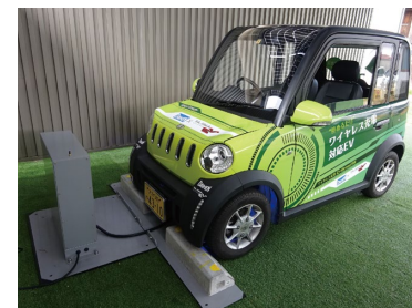
太陽光発電を活用した完全独立型の充電システム
