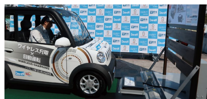
D-Broad EV CHARGING DOCKによる充電
