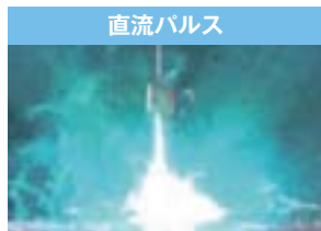
溶接電流：80A ワイヤ送給量：5.2m/min 溶接電圧：17.8V
