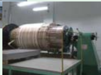
コイル(変圧器中身)と断熱壁
