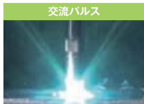
溶接電流：80A ワイヤ送給量：5.9m/min 溶接電圧：17.8V EN比率：20%
