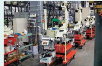
組立台車の移動を自動化することにより運搬作業の省力化と重量物搬送削減による環境改善。
