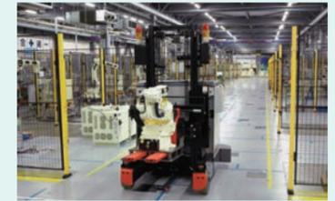
部品およびロボットの搬送を自動化することにより、運搬作業の省力化と安全性を向上。
