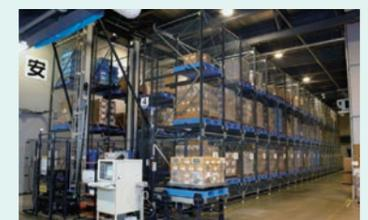
自動倉庫によるスペースの効率化と3Fピッキングエリアと連動させることで作業効率を向上。
