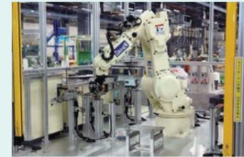
小型ロボットとパーツフィーダの組み合わせによりボルトセッティングとパレタイジングを自動化。
