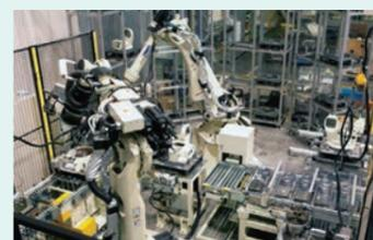
大型ロボット2台と搬送装置を組み合わせ、ベースユニットの組立作業を自動化。
