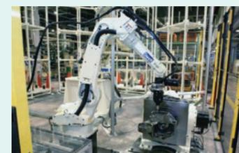
ロボット2台とポジションの構成で人手で実施していた加工パリの除去作業を自動化。
