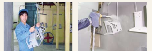
粉体塗装作業風景
