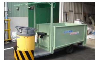
構内廃棄物収集車の電動化(十三事業所)
