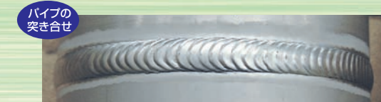
パイプの突き合せ パルス電流: 200A、ベース電流: 20A、パルス周波数: 2Hz、交流周波数: 150Hz、溶接速度: 20cm/min、板厚: 4mm (A6062)
