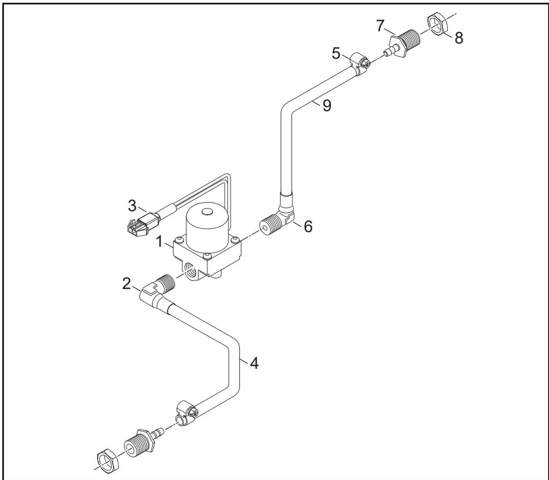
図 5 ガス配管分解図 (U30117G00)
