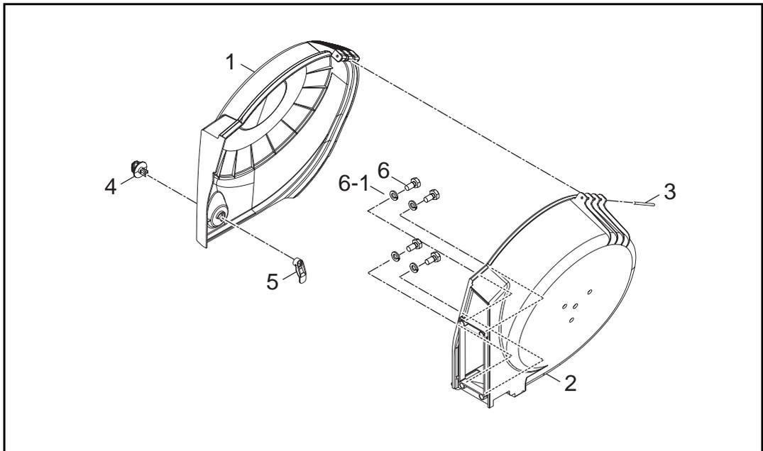
図 16 ワイヤリールカバ分解図 (K5990Q00)
