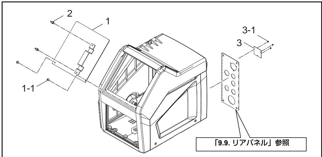
図 11 コントロールパネル分解図 (U30105P00)
