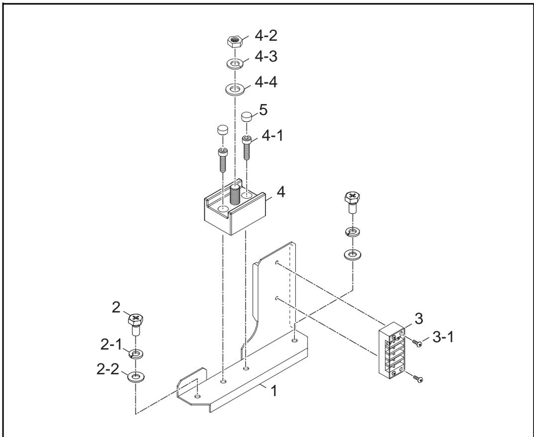
図 12 端子台ブラケット分解図 (U30105B00)
