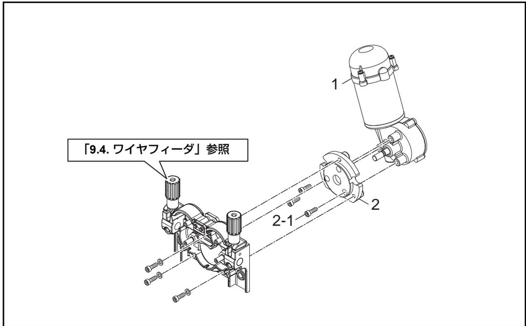
図 6 送給モータ分解図 (U30024L00)
