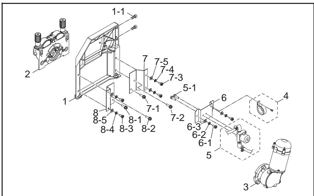
図 3 ドライブユニット分解図 (K5991B00)
