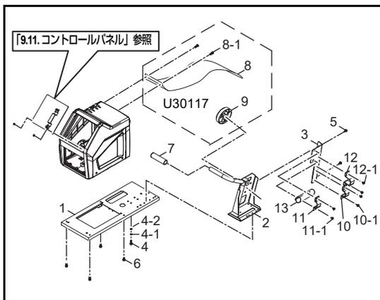
図 7-1 (旧) フレーム、ホースブラケット分解
