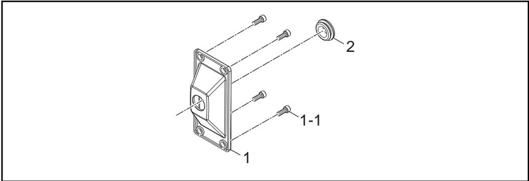
図 10 リアカバー分解図 (U30104H00)
