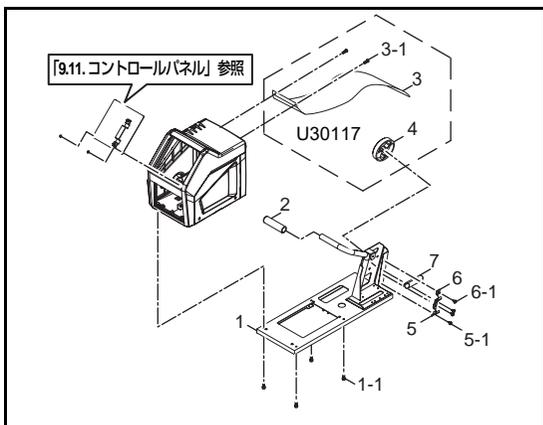
図 7-2 (新) フレーム分解図
