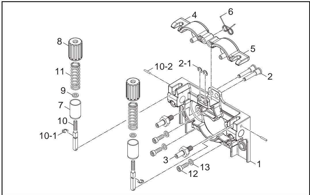
図 4 ワイヤフィーダ分解図 (U30117B00)
