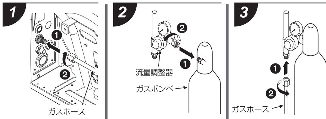
ガスホースと流量調整器はスパナで十分に締め付けてください。
