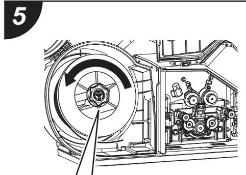
ワイヤリールを反時計回りに回して、ワイヤをインレットライナから挿入してください。
