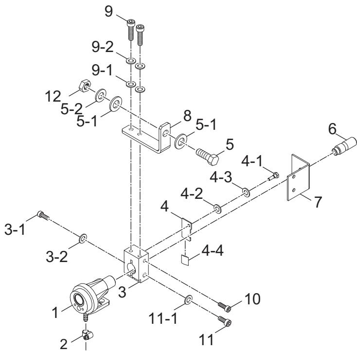
図 12-1 (旧) セントラルアダプタ分解図 (K5990D00)
