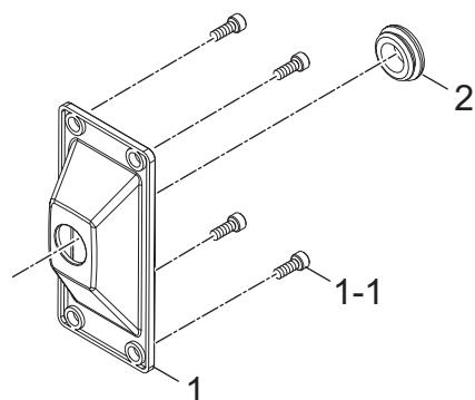
図 9 リアカバ分解図 (U30104H00)
