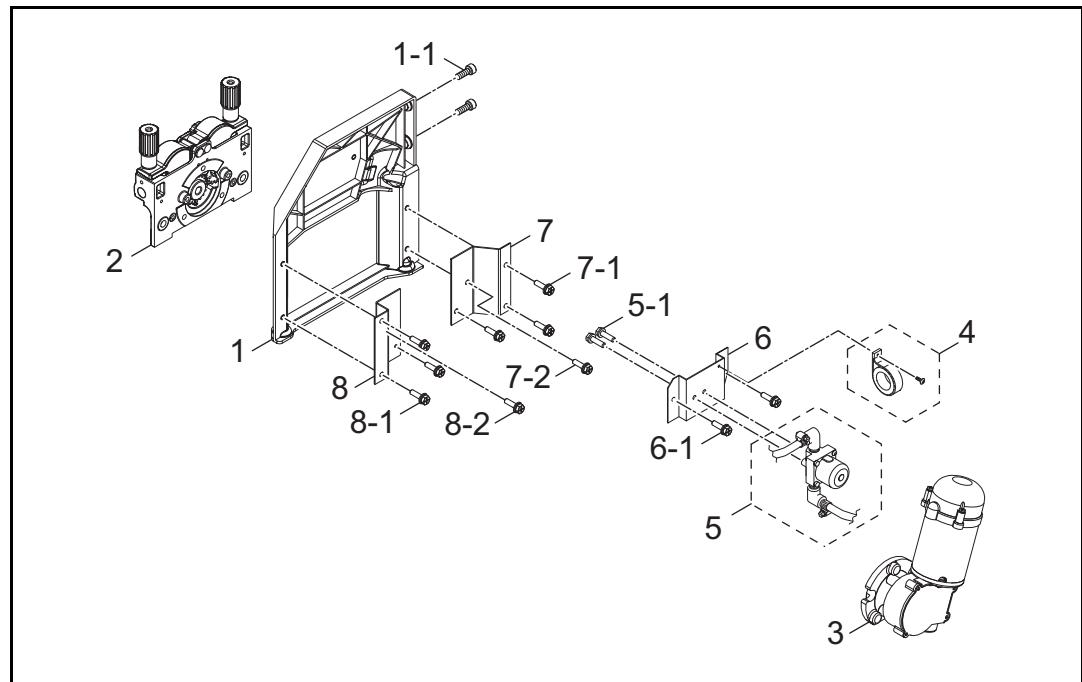
図 3 ドライブユニット分解図 (K5990B00)
