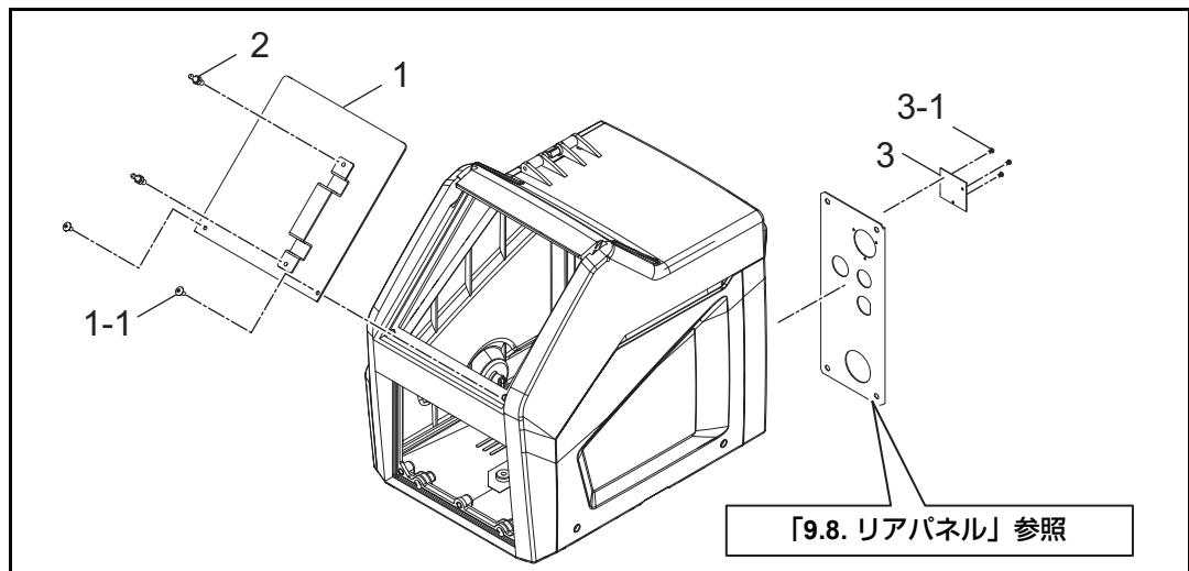
図 10 コントロールパネル分解図 (U30105P00)
