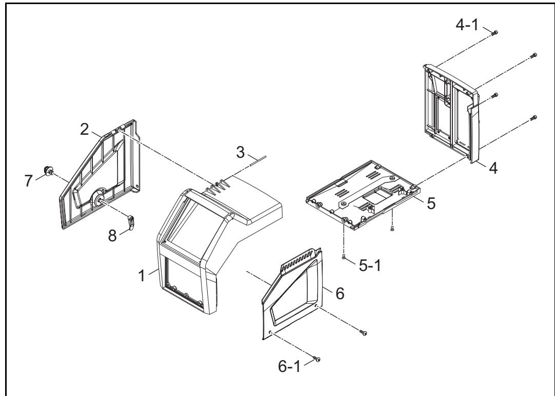
図 2 ドライブケース分解図 (K5975C00)
