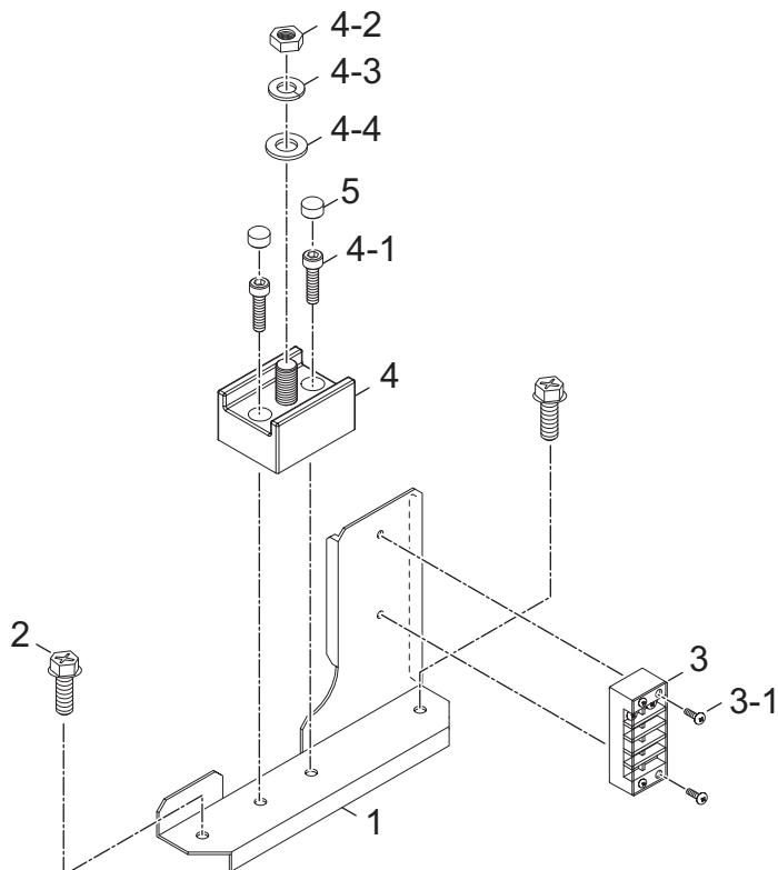
図 11 端子台ブラケット分解図 (U30105B00)
