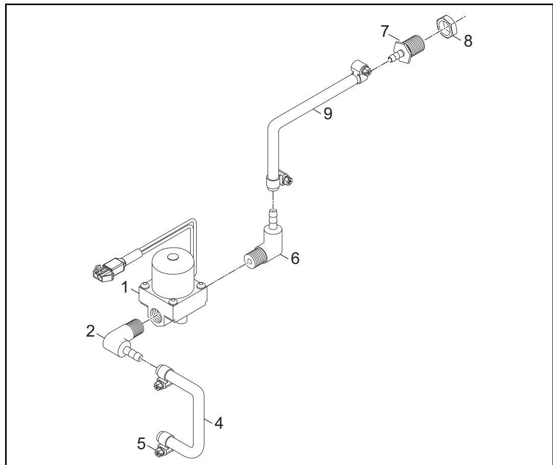
図 5 ガス配管分解図 (U30105G00)
