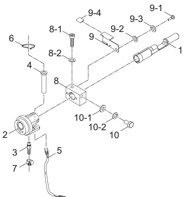
図 12-2 (新) セントラルアダプタ分解図 (U30105D00)
