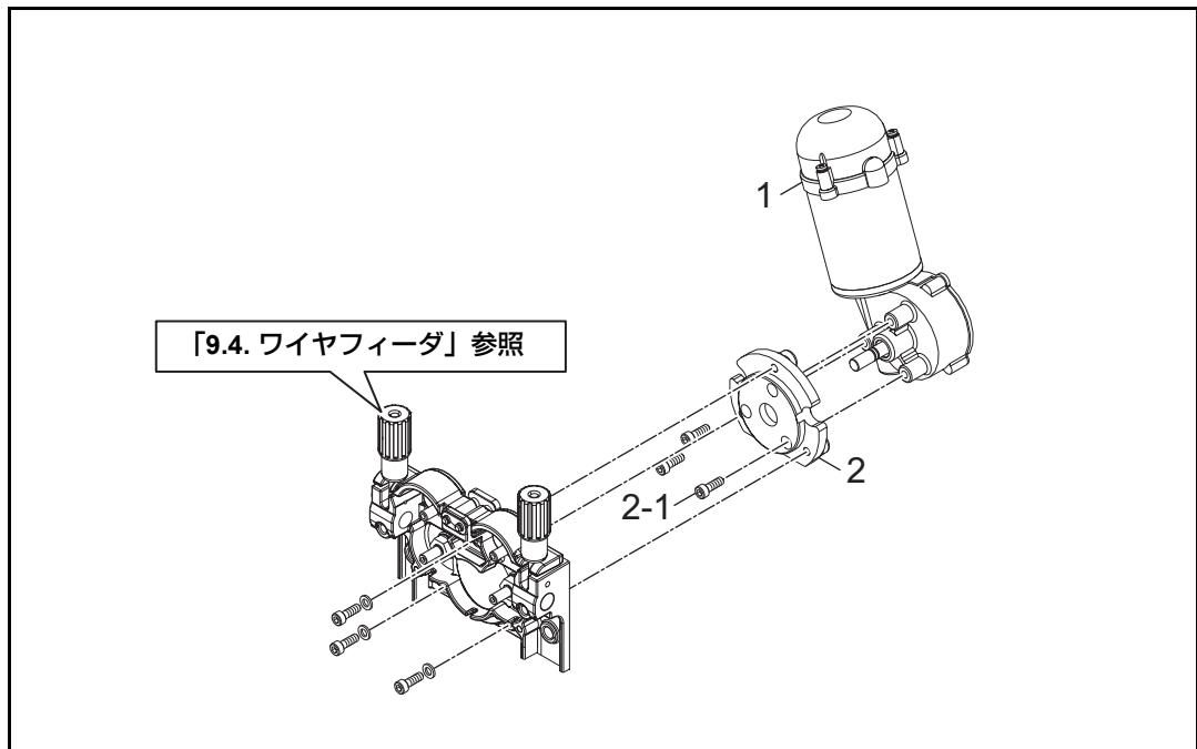
図 6 送給モータ分解図 (U30024L00)
