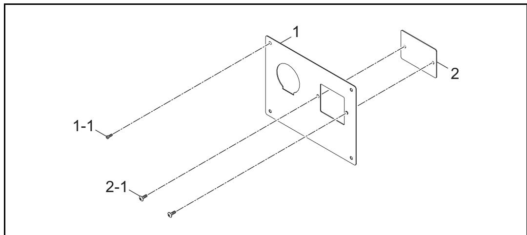
図 7 フロントパネル分解図 (U30105F00)
