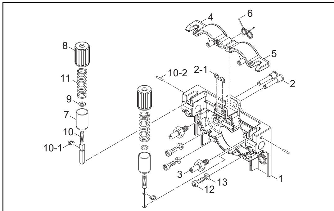
図 4 ワイヤフィーダ分解図 (K5953B00)
