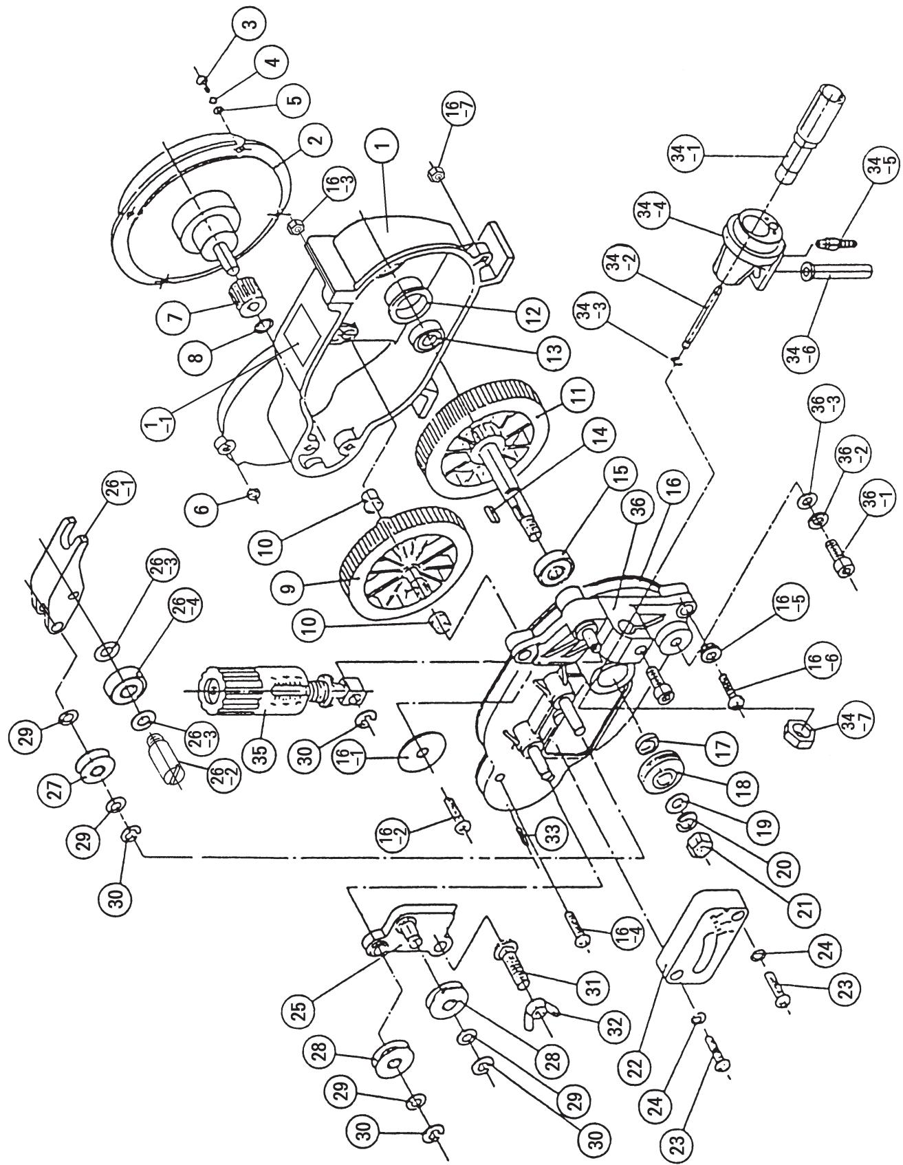
図2. ヤイヤ送給減速機分解図
