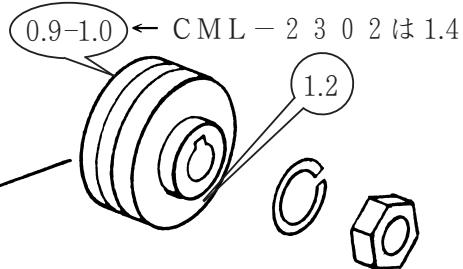
使用するワイヤサイズと同じ刻印数値が見えるように送給ロールを取付けてください。
