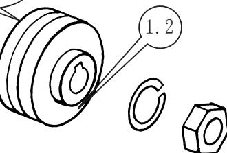
使用するワイヤサイズと同じ刻印数値が見えるように送給ロールを取付けてください。
