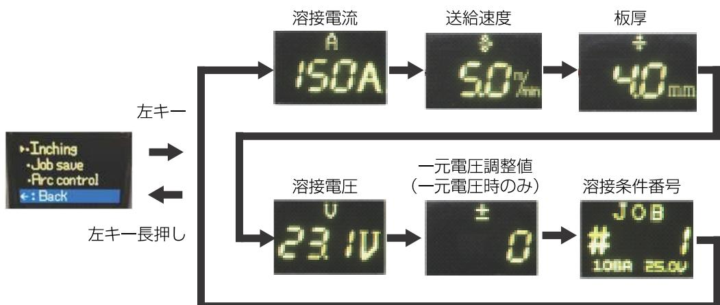
また、パラメータ設定画面にて左キーを 1 秒押すと LED の点灯 ⇄ 消灯が切り替わります。LED を切り替えたい場合は切り替わったタイミングで左キーを離してください（左キーを離さず 2 秒押し続けた場合はメニュー機能画面に切り替わり、LED 切替は解除されます）。
