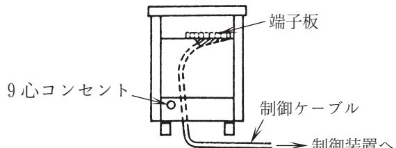
図4. 内部の端子板へ直接接続する場合
