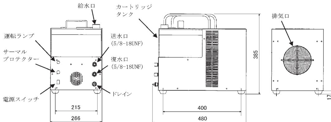
P U - 5 0 1 形冷却水循環装置外形図 (単位 mm)
