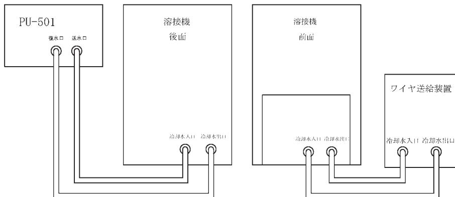
④溶接機に冷却水の入口のみがあり、ワイヤ送給装置を接続する場合
