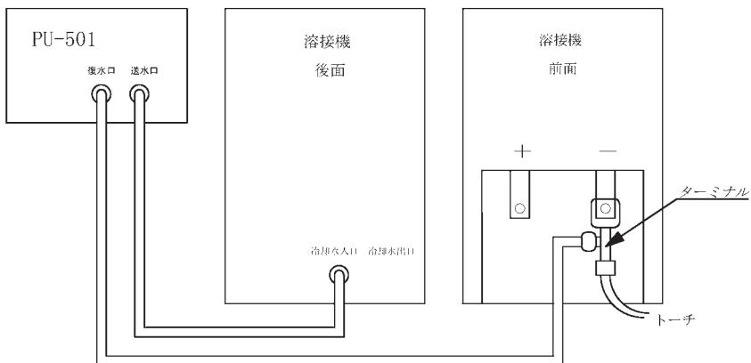
③溶接機に冷却水の入口・出口があり、ワイヤ送給装置を接続する場合
