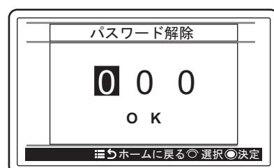
3. 画面操作ツマミを押し、選択されている桁のパスワードを入力し、ツマミを押します。
