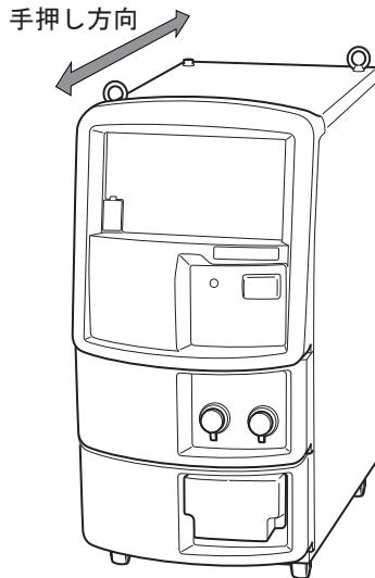
2.キャリヤなどを使用する場合は、溶接電源とキャリヤをロープなどで固定し、搬送します。
