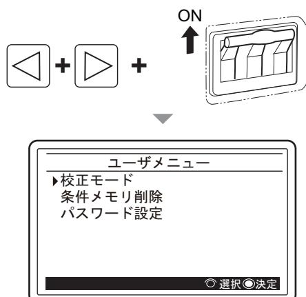
4. 画面操作ツマミを回し「校正モード」を選択し、ツマミを押します。
