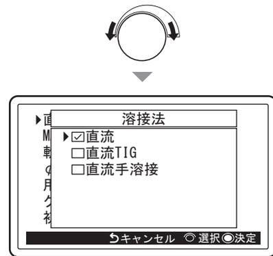
3. 他の項目（ガス、ワイヤ材質、ワイヤ径、用途、クレータ、初期条件、一元／個別）についても、各々の溶接条件設定画面を表示し、候補の選択および数値設定を行います。
