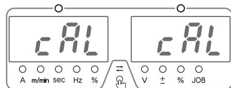
5. (抵抗負荷を接続している場合) トーチスイッチを ON にして抵抗負荷の両端電圧を測定し、電圧が  $30.0 \pm 0.1V$  となるように出力電流を設定します。
