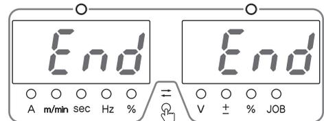
7. 左 / 右デジタルメータに「End」と表示されていることを確認し、電源スイッチを OFF にします。
