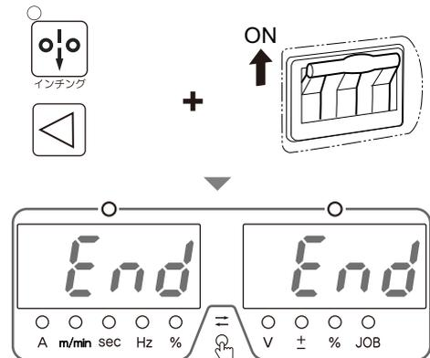
3. 左 / 右デジタルメータに「End」と表示されていることを確認し、電源スイッチを OFF にします。
