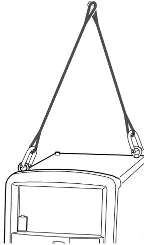
2. 吊り上げ装置を使用し、バランスに注意しながら溶接電源を吊り上げます。
