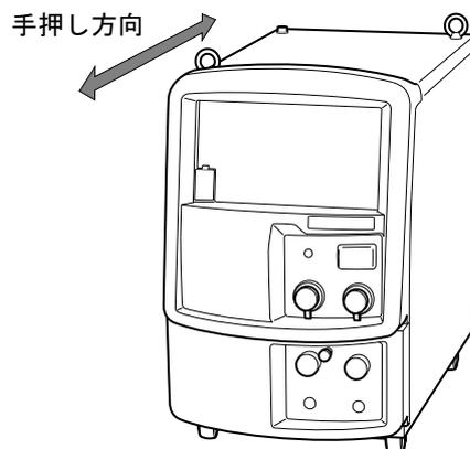
2. キャリヤなどを使用する場合は、溶接電源とキャリヤをロープなどで固定し、搬送します。
