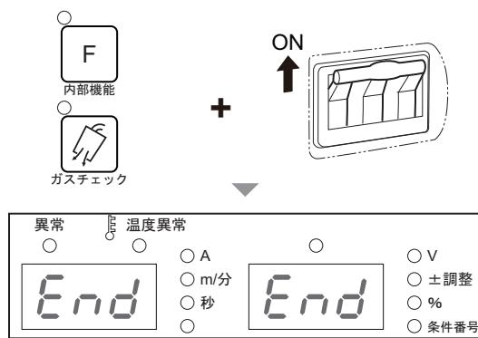
3. 左 / 右デジタルメータに「End」と表示されていることを確認し、電源スイッチを OFF にします。
