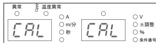
4. トーチスイッチをONにして抵抗負荷の両端電圧を測定し、電圧が $30.0 \pm 0.1V$ となるように出力電流を設定します。
