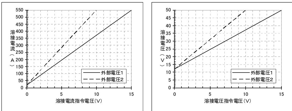
※ 外部電圧 1 : 標準の設定で、外部より 0V ~ 15V の範囲で指令電圧を供給する場合
