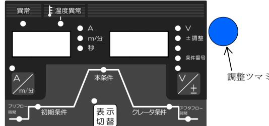
設定するパラメータを表示切替キーで選択します。選択後、パラメータ調整ツマミで値を設定します。
