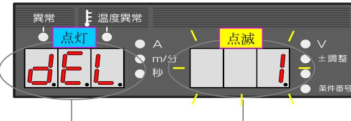
削除モードを表す『d E L』を点灯表示。 削除する条件番号が点滅表示される。
