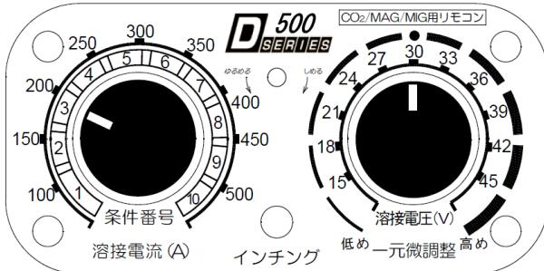
※上記の例では溶接条件 No. 3 の記憶を読み出して記憶されたままの溶接電圧に合わせた状態です。
