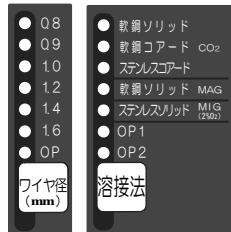
溶接法切替キーで、ご使用になる溶材とシールドガスとワイヤ径を選択します。
