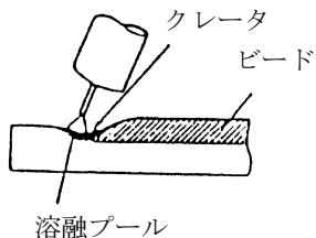
溶接終了部には、クレータという凹みが残ります。この凹みは割れや溶接欠陥になることがあるため、極力小さくする必要があり、この処理のことをクレータフィラといいます。
