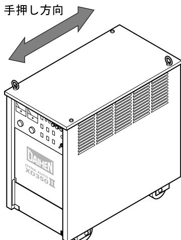
2. キャリヤなどを使用する場合は、溶接電源とキャリヤをロープなどで固定し、搬送します。
