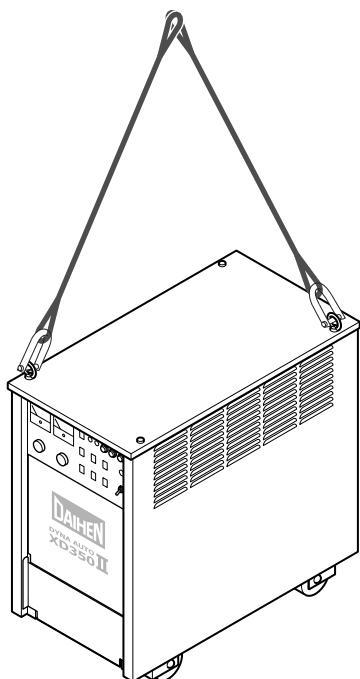
2. 吊り上げ装置を使用し、バランスに注意しながら溶接電源を吊り上げます。
