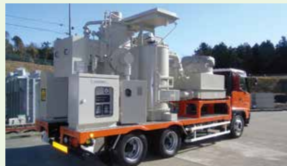
■三相77kV 10MVA トラック積載移動用変圧器
