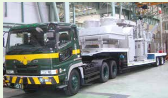
■三相110kV 15MVA トレーラ積載移動用変圧器
