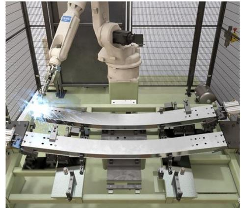
標準(溶接)ロボットセルパッケージ事例
