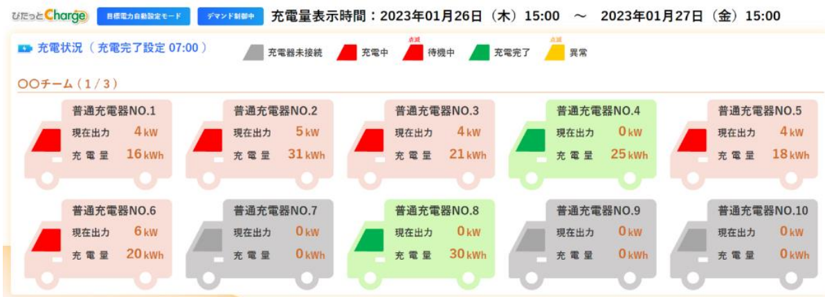
<図2> 充電状況監視モニター
