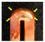
抵抗発熱を抑制し、 損失の低下に貢献
