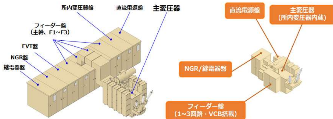
【図2】従来方式との専有面積比較
