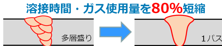
【図3】開先面積削減事例
