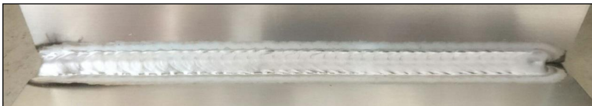
溶接条件 溶接電流：100A、電圧：11.0V、速度：70cm/min、 円弧ウィービング、板厚1.5mm T字隅肉
