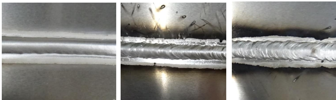
図2 シンクロフィードのアルミ溶接と従来溶接法との比較
