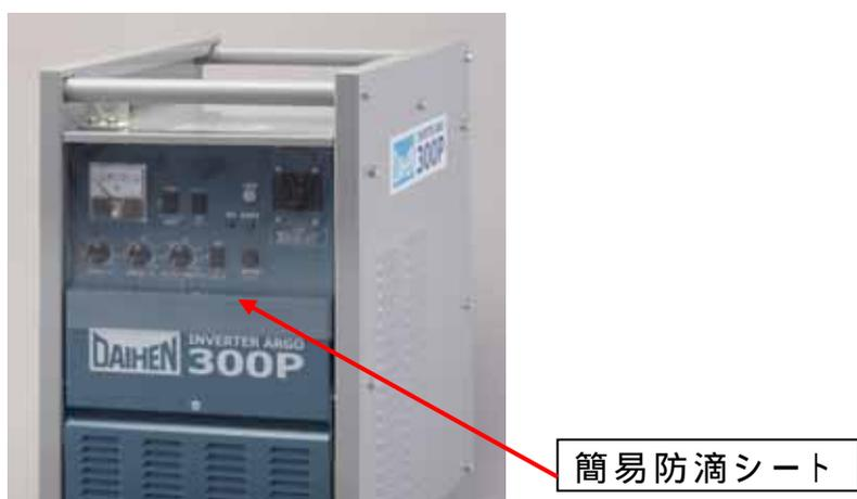
ケースガードで運搬時の不用意な衝突からガス・水接続金具や入力端子台を保護します。
