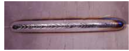
チタン合金突き合わせ溶接 板厚：2.0mm、溶接電流：120A パルス周波数：5Hz
