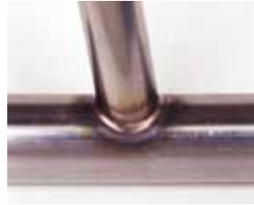
ステンレスパイプ全周溶接 板厚：2.0mm、溶接電流：150A パルス周波数：10Hz
