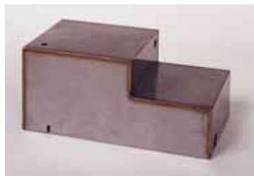
ステンレス拌み継ぎ手 板厚：0.3mm、溶接電流：10A パルス周波数：500Hz
