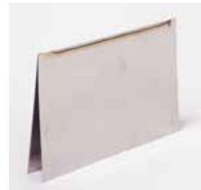
ステンレスカド溶接 板厚：1.5mm、溶接電流：80A パルス周波数：5Hz
