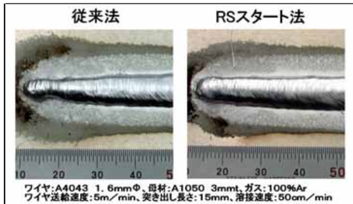
「RSスタート制御」によるビード外観の比較
