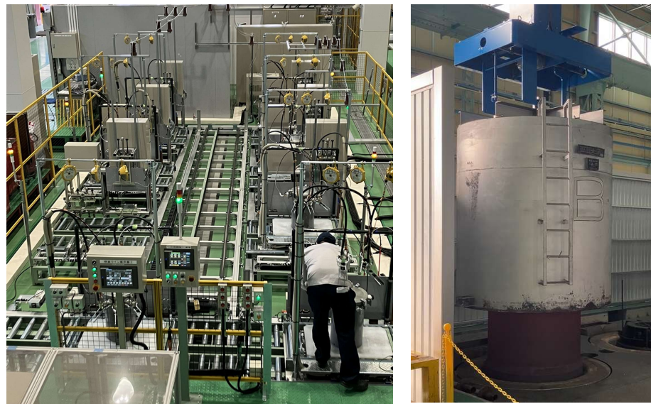
柱上変圧器工場の生産機能集約及び鉄心・検査工程の自動化 ⇒生産性22%向上
