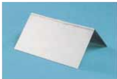
ステンレス0.3mmのカド溶接
