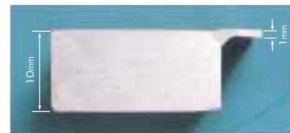
ステンレス板厚違いの溶接 溶接電流 30アンペア (パルス周波数 1.6Hz) (パルス幅 50%)
