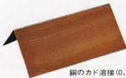
鋼のカド溶接(0.3ミリ) 溶接電流50アンペア 高速パルス100Hz
