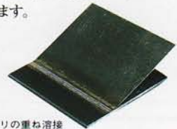
ステンレス0.1ミリの重ね溶接 (下板1.0ミリ) 溶接電流15アンペア
