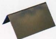
ステンレスの板厚違いカド溶接 (0.2ミリ・1.5ミリ) 溶接電流15アンペア 高速パルス100Hz
