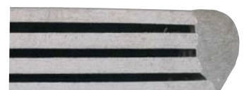
へり継手溶接の断面マクロ
