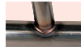
板厚: 2mm, 溶接電流: 150A, パルス周波数: 10Hz
