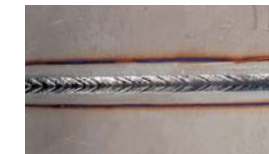
板厚: 2mm, 溶接電流: 120A, パルス周波数: 5Hz
