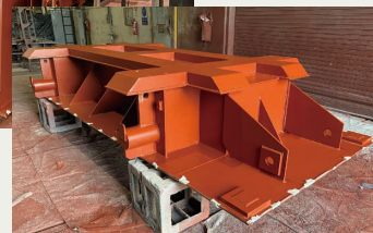
塗装乾燥中の変圧器ベース
