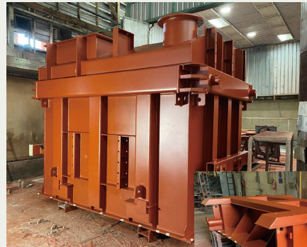
塗装乾燥中の変圧器ケース
