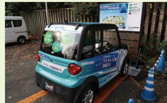
設置しているLED掲示板で、車両検知や充電状況などを確認できます。
