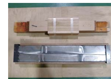
コイル巻線の巻枠を金型化 (上)旧巻枠(ベニヤ製) (下)新巻枠(鉄製)
